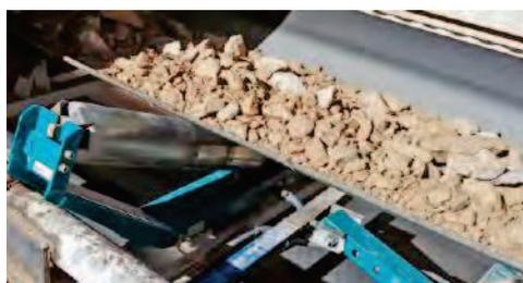
Pesaje continuo para la industria minera y extracción de arenas / áridos.
