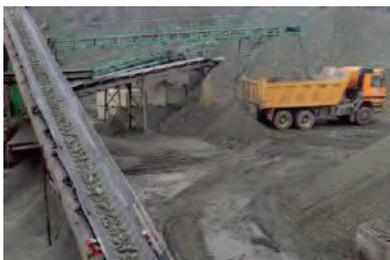
Aplicación carga camión dosifica la cantidad de material deseada, ahorrando tiempos al realizar la carga directa.
