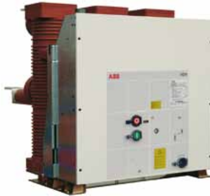
Interruptor HD4 36 kV fijo con intereje polos de 275 mm: I_r = 1250-1600 A; I_{sc} = 25-31,5 kA I_r = 2000-2500 A; I_{sc} = 20-25-31,5 kA.
