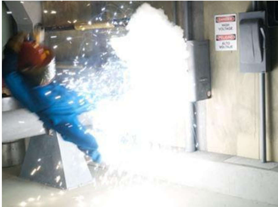
FIG. 1 arco eléctrico afectando operario.
