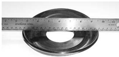
Un ejemplo de espaciador del tubo del buje “copeado”. El calor generado por la fricción provoca que el espaciador se “moldee” o “copee” alrededor del buje y del tubo del buje. Esto es normal en la medida en que el espaciador se mantenga intacto y no se rompa o despedace.
