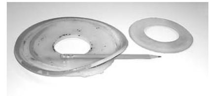
Ejemplo de un espaciador de tubo del buje “destrozado”. El espaciador del lado derecho es un ejemplo de desgaste extremo. Su circunferencia ha sido completamente cortada por el tubo del buje.
