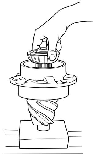
5. Aplique la carga de sujeción al conjunto de la jaula del rodamiento del piñón. Instale el yugo (o el engrane helicoidal) y apriete la tuerca del piñón según las especificaciones o utilice la prensa para simular el torque de la tuerca (consulte la tabla de la página siguiente).
