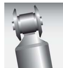
Ejemplo de instalación inadecuada: rondanas instaladas al revés (si esta equipado)
