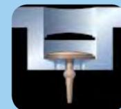
La válvula tipo "paraguas" ventila la presión, incluso cuando está cubierta con 1/4" de grasa; el deflector ofrece protección adicional contra los lavados a presión
