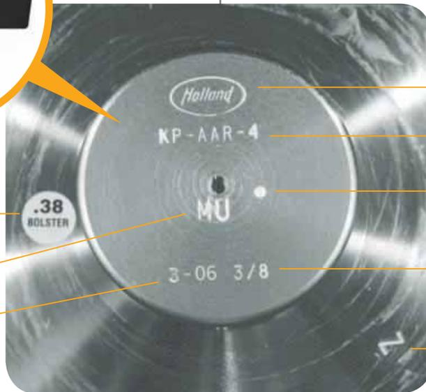
ESPESOR DE LA PLACA DEL ACOPLADOR SUPERIOR
