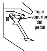
**! IMPORTANTE: NO REAJUSTE EL EMBRAGUE.** No modifique el juego libre reajustando el varillaje del embrague.
