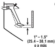
**8** Para cambiar el juego libre, ajuste el tope superior del pedal para levantar o bajar el pedal en la cabina.
