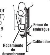
• Si no se aprieta, vuelva al Paso 1 y reajuste el varillaje del embrague.
