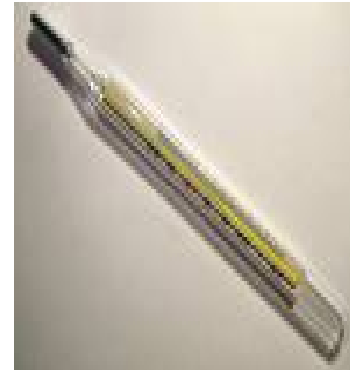
Termómetro de mercurio de bulbo seco
