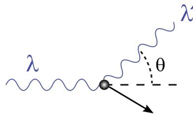
Ein Photon führt einen vollständig elastischen Stoß mit einem freien (ruhenden) Teilchen wie z.B. einem Elektron durch. Hierbei gibt es einen Teil seines Impulses an das Teilchen ab, wodurch die Wellenlänge vergrößert wird. Diese Vergrößerung wird mathematische beschrieben durch:
