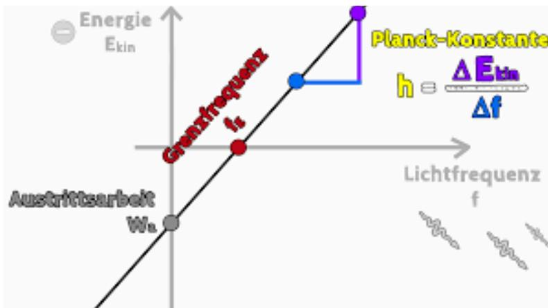
Grenzfrequenz  $f_0$  ist eine Frequenz, die das einfallende Licht mindestens besitzen muss, um Elektronen aus einer Metallplatte herauszulösen. Die Einheit der Grenzfrequenz ist Hz .
