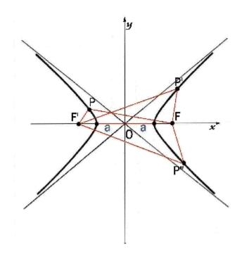
Denotiamo con F ed F rispettivamente, i due fuochi. Fissiamo un sistema cartesiano (OXY) tale che l'asse x passi per i punti F' ed F e l'origine sia il punto medio del segmento FF'. Allora i due fuochi avranno coordinate  $(\pm c,0)$ . Il punto P(x,y) verifica la condizione d(P,F)-d(P,F')=2a se e solo se
