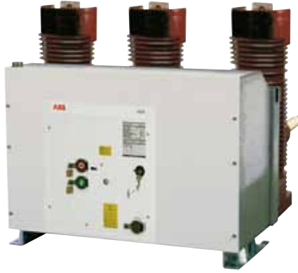
Interruptor HD4 36 kV fijo con intereje polos de 350 mm: I_r = 630-1250-1600 A; I_{sc} = 16-20 kA.
