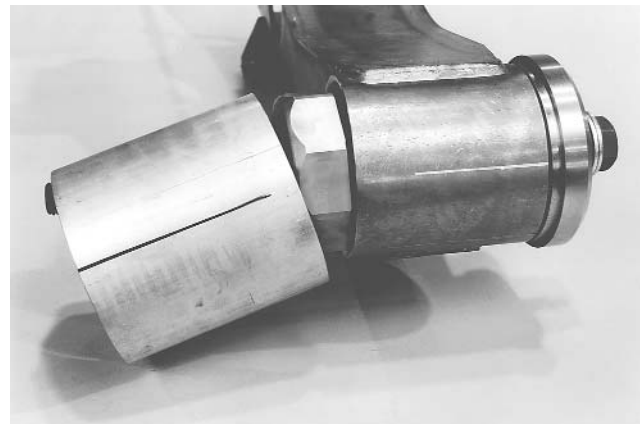
Figura 34. Continúe apretando el tornillo después de que el tubo de transición caiga
