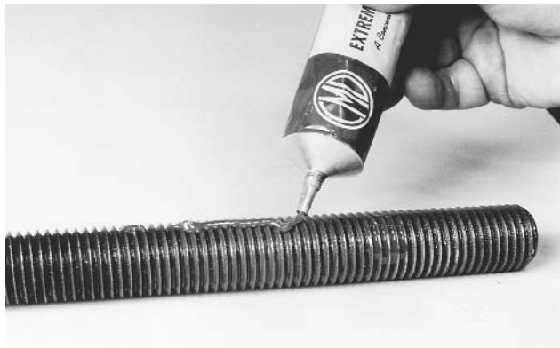
Figura 10. Aplique lubricante al tornillo de cabeza hexagonal
