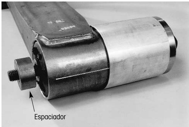
Figura 15. Instalando el espaciador
