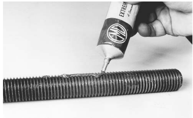
Figura 26. Aplique lubricante al tornillo de cabeza hexagonal
