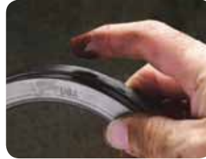
Lubrique ligeramente el diámetro externo e interno con el fluido a ser retenido.
