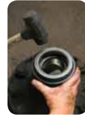
Se puede usar un martillo de caucho para golpear suavemente a su posición final.
