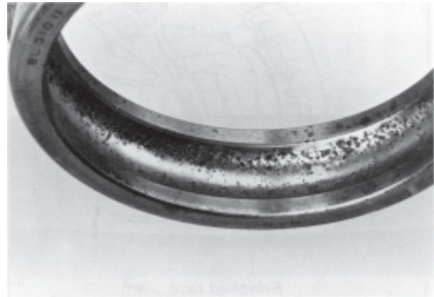
Rodamiento quemado y astillado
