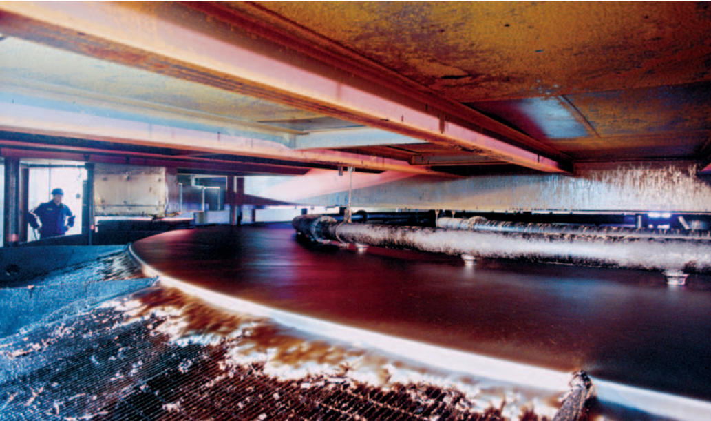
Auslösung von Öl aus Teersand mit Hitze, Wasser und Lösungsmitteln. Bild: Suncor Energy Inc.
