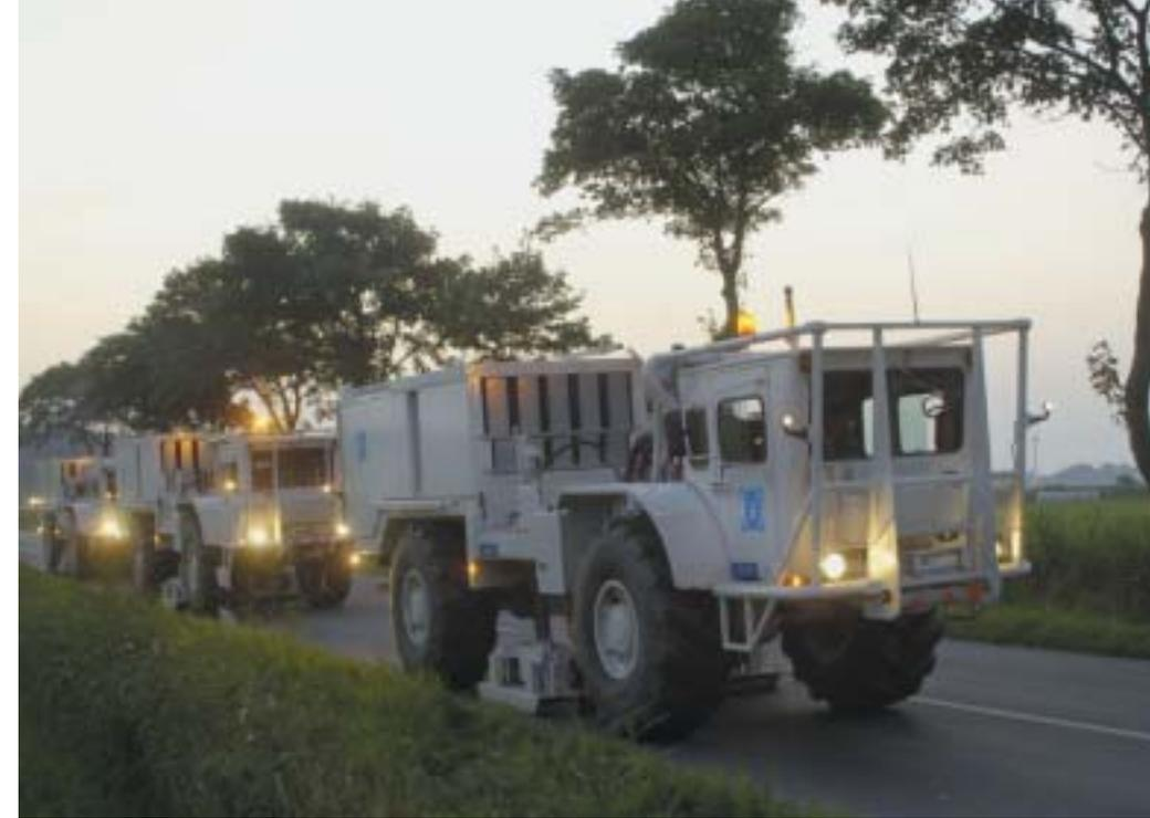
*Auf festem Untergrund werden Schallwellen mit Hilfe von Vibratoren erzeugt.*
