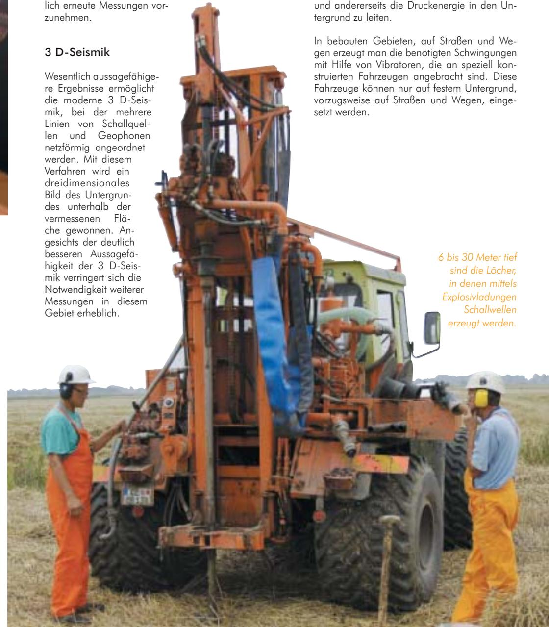
*6 bis 30 Meter tief sind die Löcher, in denen mittels Explosivladungen Schallwellen erzeugt werden.*
